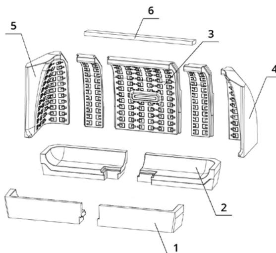
esempio allestimento camera di combustione Therm 10
